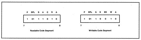
Figure 7-8. Access Byte Example
